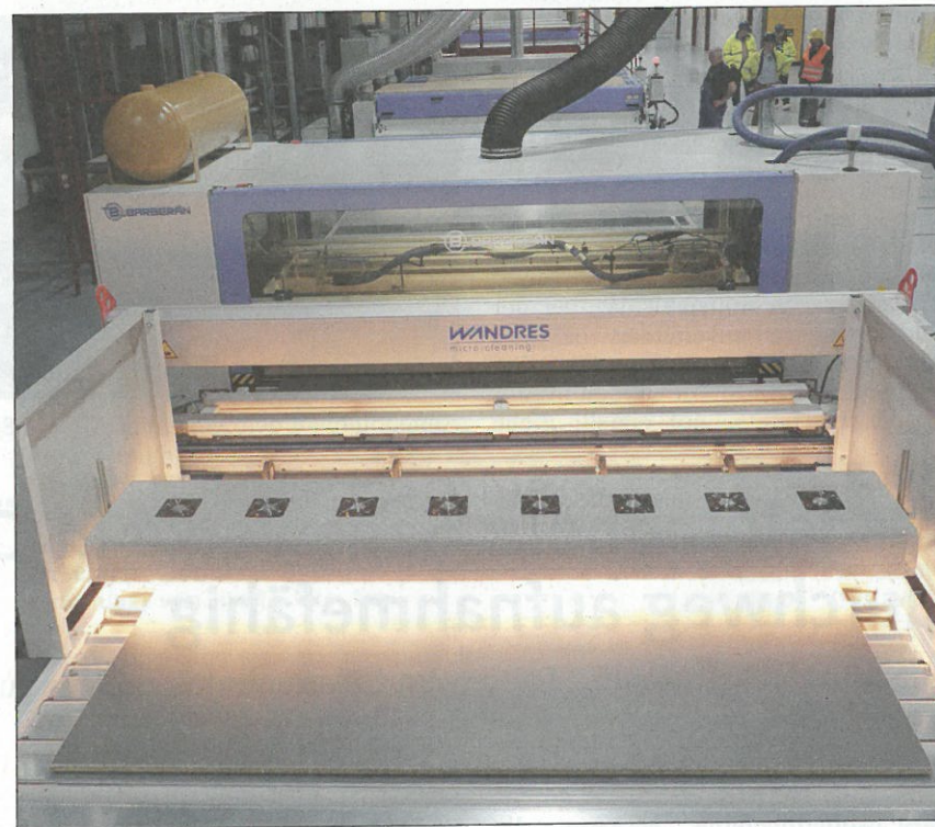
In einem aufwendigen, mehrstufigen Verfahren werden die Holzwerkstoffe in Leutkirch beschichtet. Foto: Bolz
