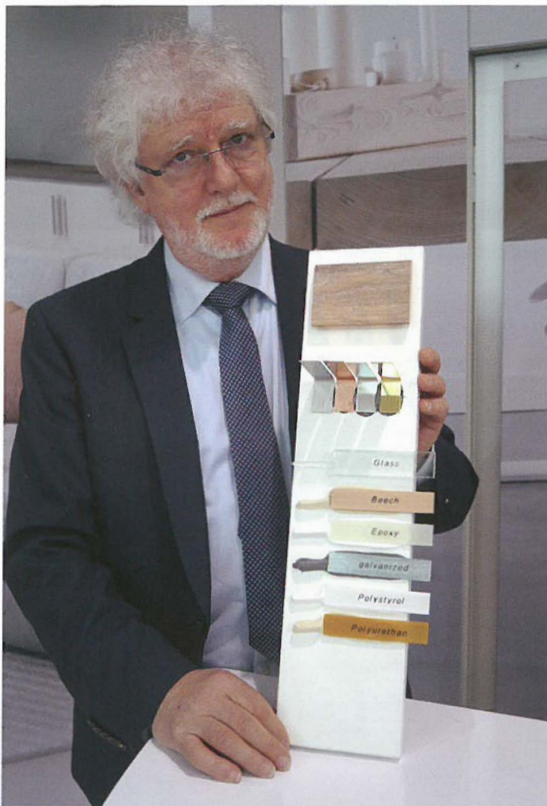
Peter W. Mansky, Leiter Marketing und Kommunikation, zeigt eingefärbte, silanterminierte Polymerklebstoffe zur Anwendung bei unterschiedlichen Werkstoffen.
